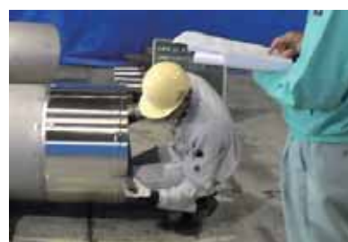
日本水道協会検査員による立会検査
