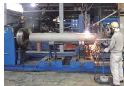
三次元 CAD で作図した形状で切断
